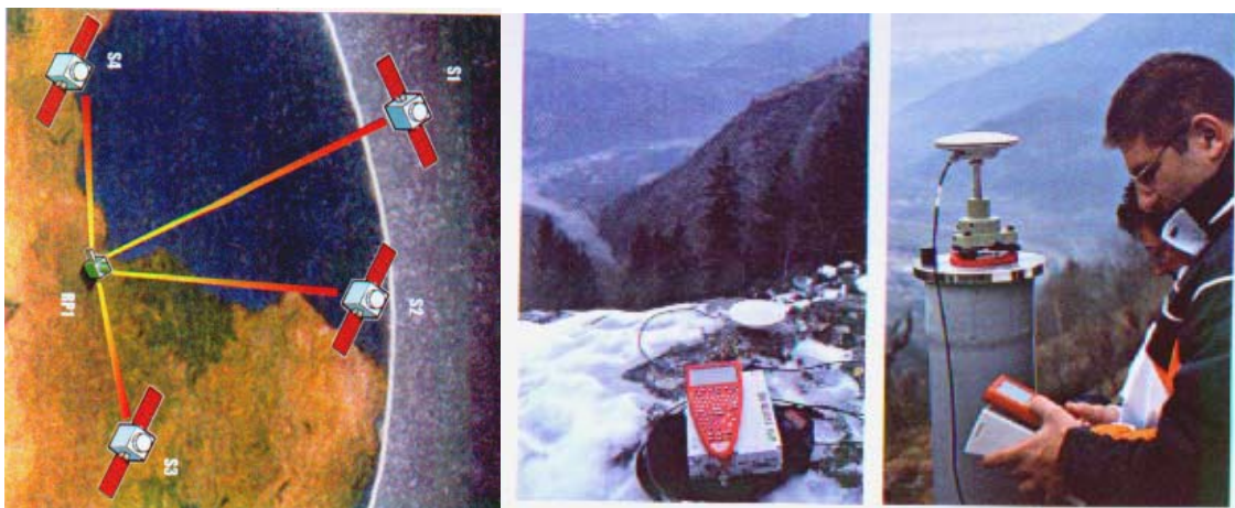
figura 5: Strumentazione GPS e principio di funzionamento
