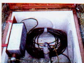
Testa di un tubo piezometrico attrezzato con sensori di livello
